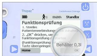
3. Kontrolle der angezeigten Behältergröße (bei falscher Angabe Behälter entsorgen)
