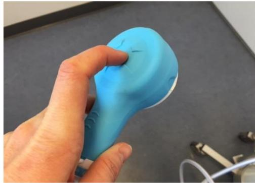
6. Flaschenventil wieder schliessen und System entlüften (in der Mitte drücken, bis Druck vollständig abgelassen ist)
