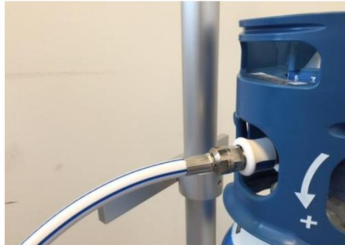
1. Stecker in die Schnellkupplung stecken, bis die Kupplungshülse einrastet.
