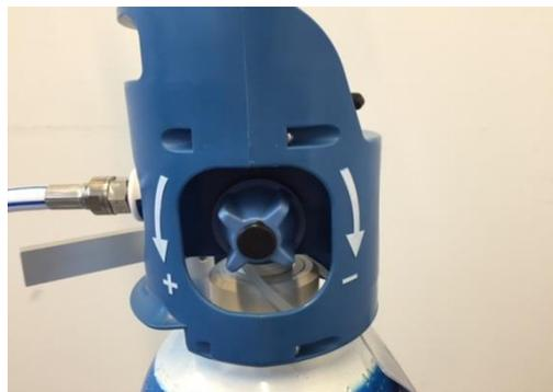
2. Flaschenventil gegen den Uhrzeigersinn in Pfeilrichtung + öffnen.
